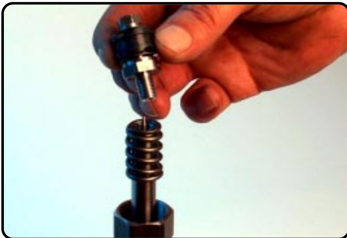
Remove the rod tap "complete".
