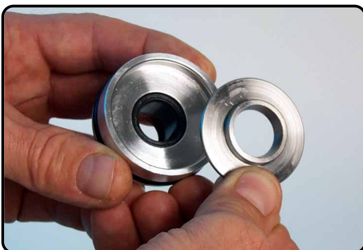
Replace the steel disc.
