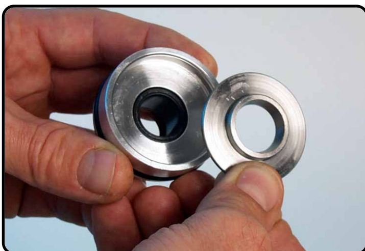
Replace the steel disc.
